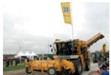
Foto 6. De kleinste en de grootste bunkerrooier op Beet Europe hebben een gelijke maximale wiellast. Bij Ropa (links) is dat gerealiseerd door een betere gewichtsverdeling over alle wielen.
